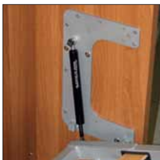
Ribaltamento a pistone. Potenza pistone da 800N a 1450N in base al materasso
